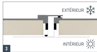
3 Profils à rupture de pont thermique
